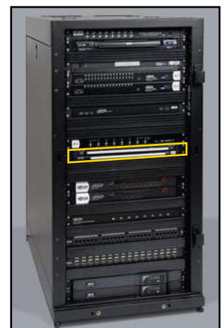
Las consolas de rack se pliegan como una laptop y se deslizan dentro de una gaveta de rack 1U.
