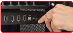
El puerto USB de enlace de subida se conecta a una computadora para sincronizar dispositivos.
